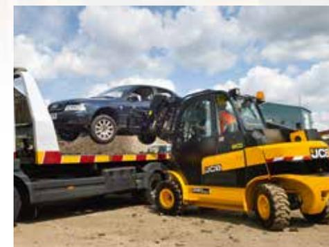
Il Teletruk consente di ottenere risparmi fino al 30% sui costi operativi rispetto a un carrello elevatore a forche con montante. Questo risultato è dovuto ai risparmi in termini di tempo, spazio e carburante tipicamente correlati all'esecuzione delle operazioni di carico da un lato solo.
