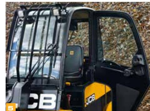
La sterzata completamente idrostatica, insieme al diametro ridotto del volante e al comando del servosterzo, garantiscono precisione nelle manovre.
