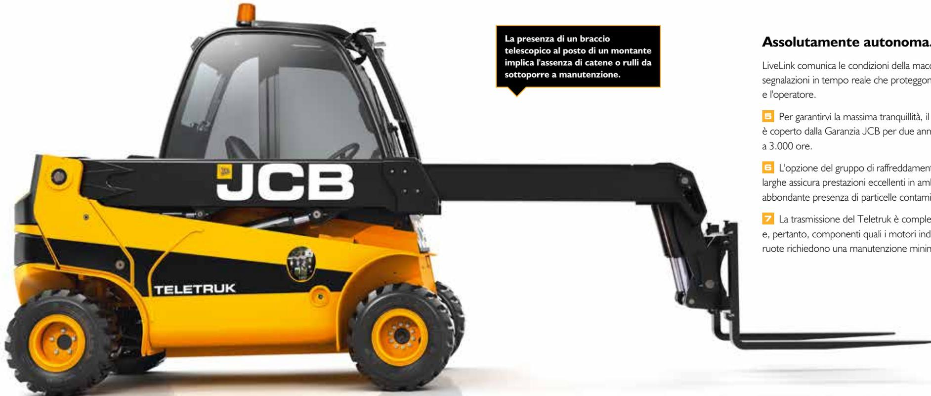
La presenza di un braccio telescopico al posto di un montante implica l'assenza di catene o rulli da sottoporre a manutenzione.
