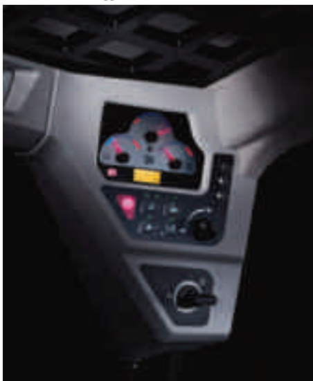
Il quadro comandi destro comprende le funzioni diagnostiche della macchina, l'acceleratore elettronico e l'accensione.
