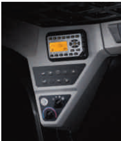
I comandi della macchina sono disposti in posizione strategica sul padiglione all'altezza degli occhi dell'operatore..
