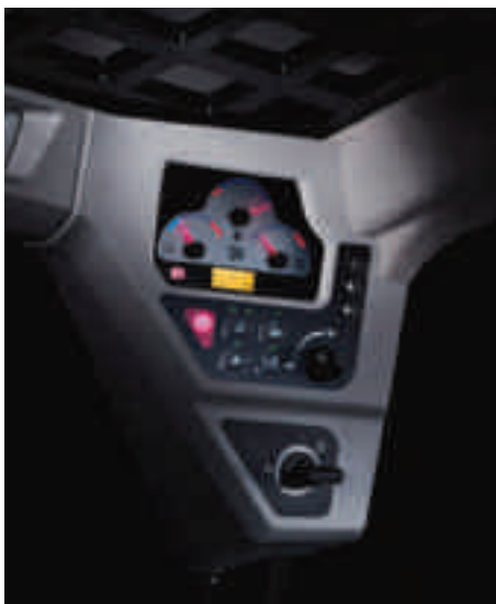
Il quadro comandi destro comprende le funzioni diagnostiche della macchina, l'acceleratore elettronico e l'accensione della minipala.
