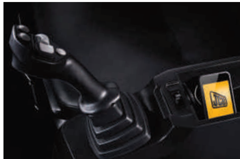
Un joystick multifunzione consente all'operatore di azionare svariate attrezzature a comando idraulico. Il bracciolo sinistro comprende anche un vano portaoggetti.
