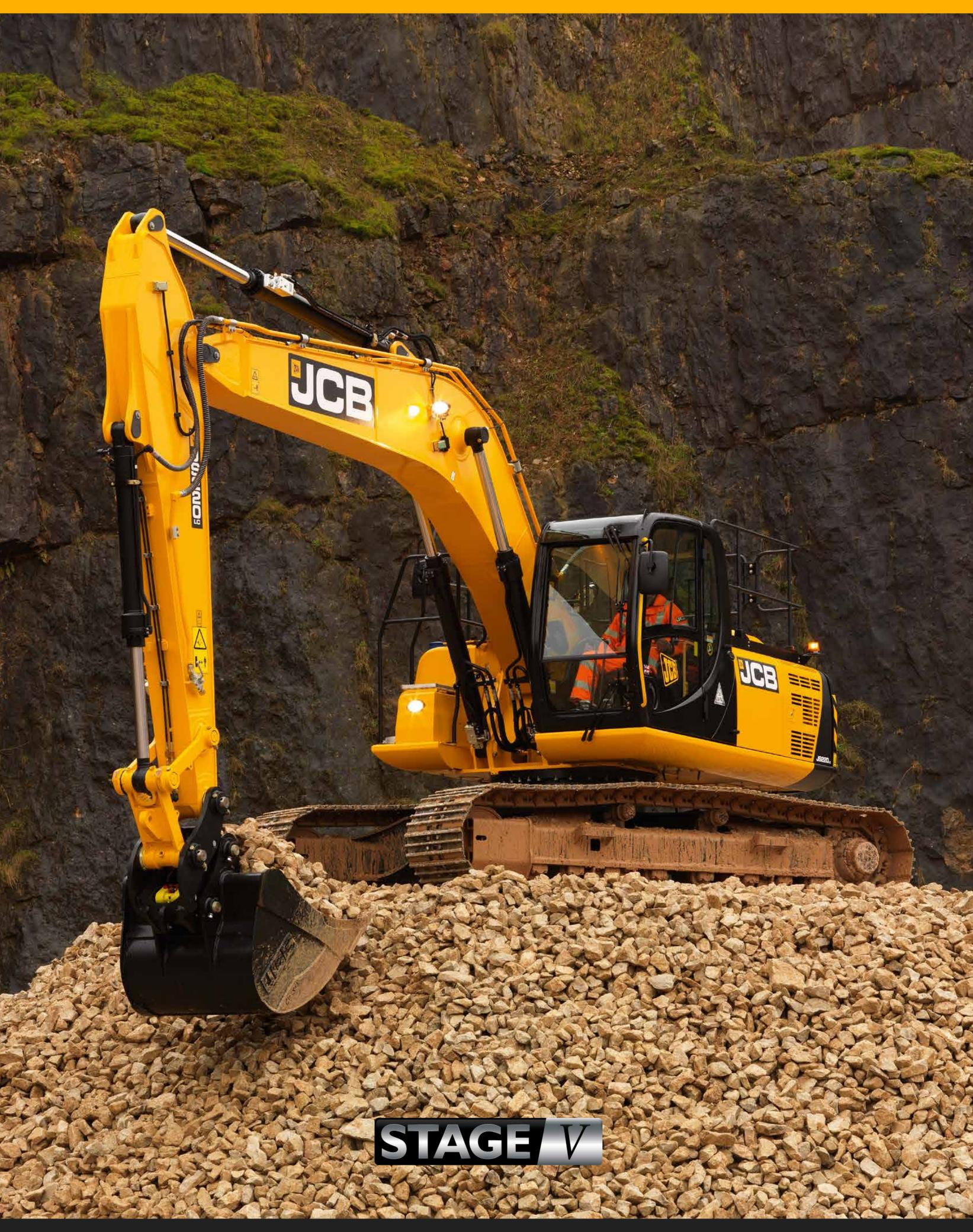
PESO OPERATIVO MASSIMO 22446 - 24487 kg POTENZA MASSIMA DEL MOTORE 129 kW
